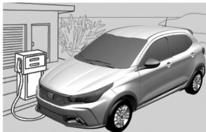
Para asegurar el reaprovisionamiento total del tanque de combustible, hacer dos operaciones de llenado después del primer clic de la pistola.
