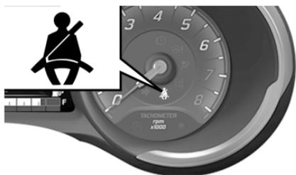
Cuando el vehículo se detiene, si el cinturón de seguridad en el lado del conductor se suelta, la luz sigue encendida de manera fija.
